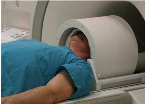
在线圈的一般使用情况下，容积线圈用于发射，阵列用于接收。这样可达到最大灵敏度，以及最大加速平行成像能力。在该模式下，三十二个阵列通道全部可用于接收。然而，系统在使用容积线圈时，也可同时将其用于发射和接收。这对于许多应用有用，例如匀场、定位，以及需要更均匀的其他接收场的其他操作。
